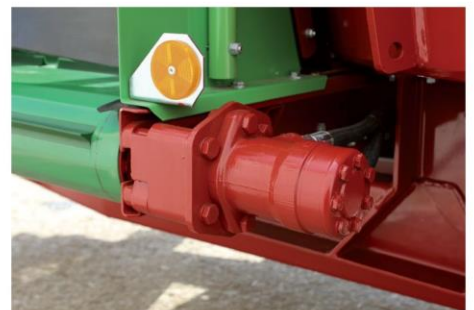
Hidrauliskie motori - atkarībā no pielietojuma jūs varat izvēlēties dažādus motorus ar dažādiem apgriezieniem.
